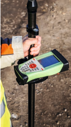
Rilevamento con ricevitore GPS
